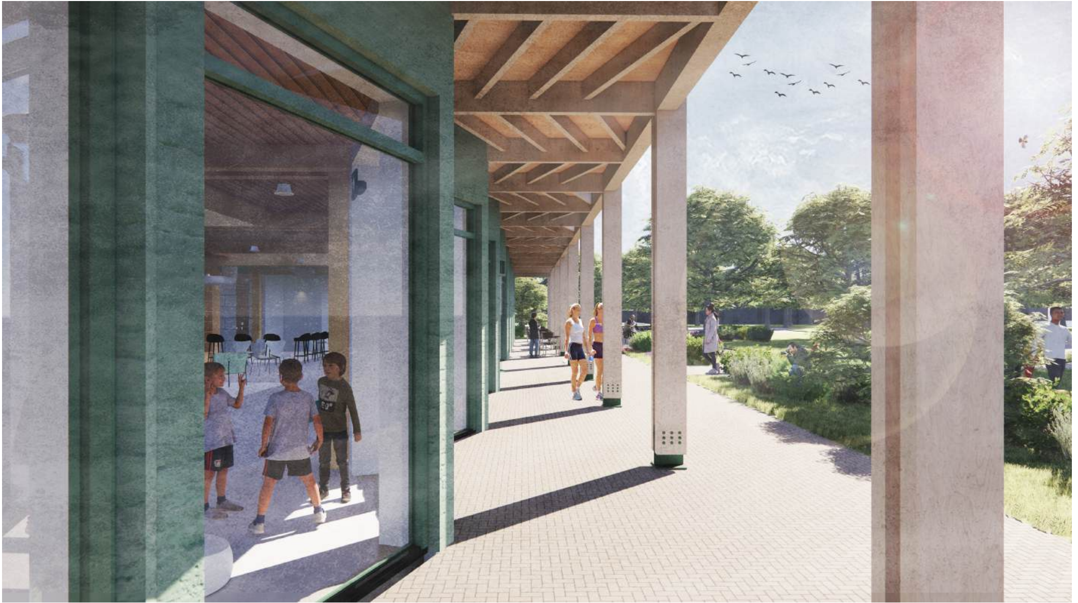
De kinderbinten van de luifel zijn geogst uit het originele gebouw en geven de overspanning hetzelfde karakter als de zig-zag in de gevel
